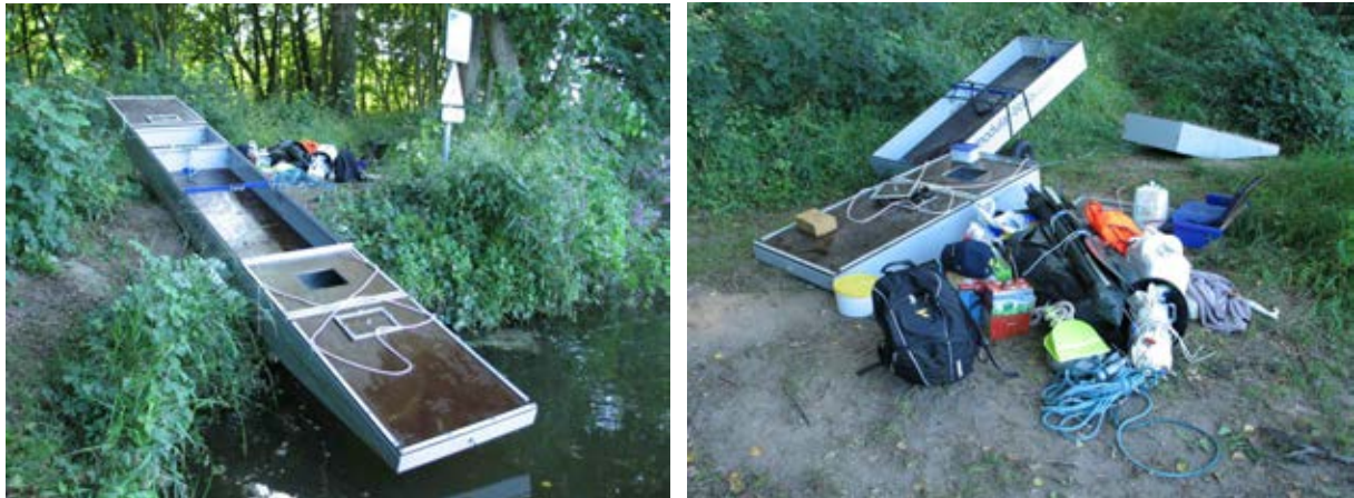
Abb. 11: Das Umtragen war aufgrund der Modulbauweise und mit Hilfe eines Bootswagens auch alleine machbar
