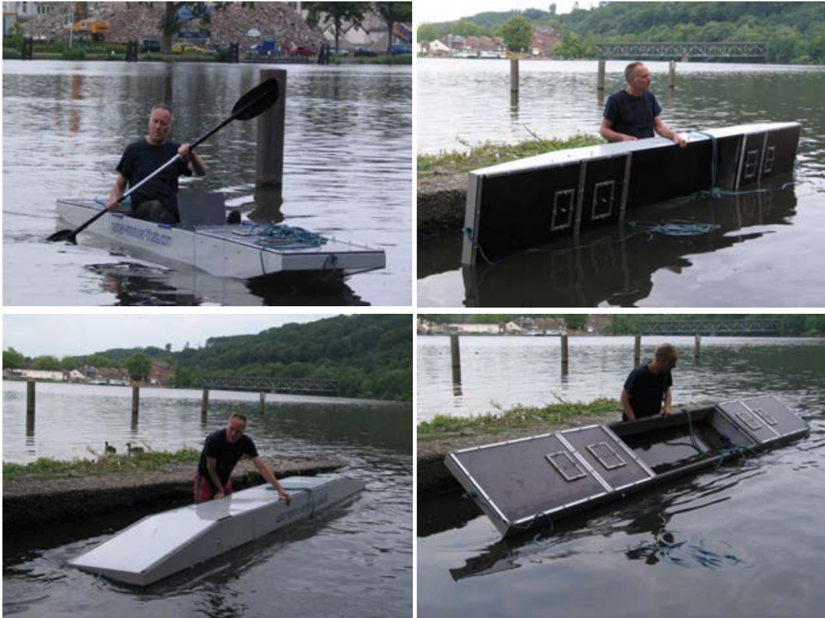
Abb. 8: Testfahrt und Kenterversuch auf der Ruhr bei Kettwig
